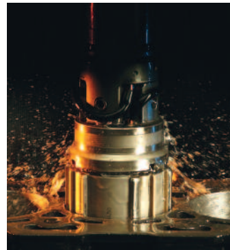
Das erstmals in einer Feinbohr/Hon-Linie für Zylinder-Kurbelgehäuse eingesetzte HighSpeed-Hon-Werkzeug überzeugt mit einer 7-fach höheren Abtrags- und einer bis zu 15-fach höheren Aufweitrate als bislang gewohnt.
