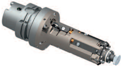
Das 5-schneidige, aussteuerbare HSK 100-Feinbohr-Werkzeug für das Semi-Finishen unmittelbar vor dem HighSpeed-Hon-Prozess: ausgelegt zum (natürlich) automatischen Werkzeugwechsel.
